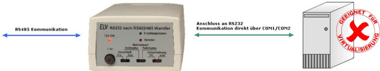
Der PC verfügt über eine RS232-Schnittstelle, die Kommunikation läuft in diesem Fall meist über COM-Port 1 oder COM-Port 2.
