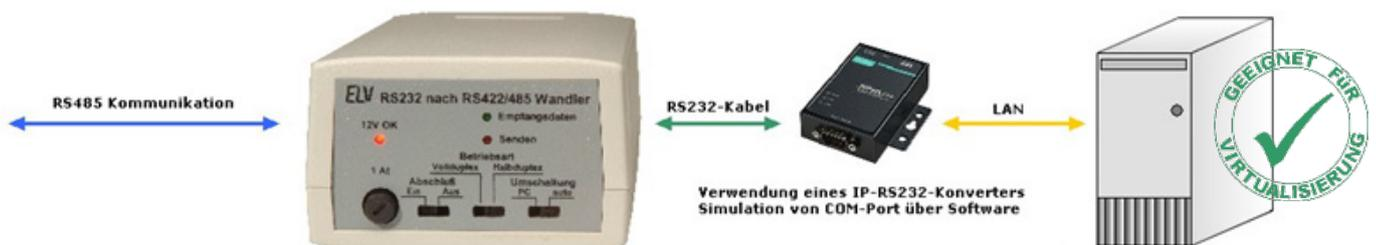
In diesem Fall wird der Wandler über einen IP-Konverter (Art.Nr. 145045) angesteuert. Eine Simulation des COM-Ports im PC erfolgt über die mitgelieferte Software. Der IP-Konverter bietet den Vorteil einer flexiblen Installation an beliebiger Stelle im Firmennetzwerk.
