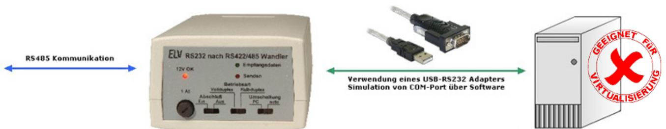
Der Anschluss erfolgt über einen USB-Adapter (Art.Nr. 144872). Für die korrekte Funktion muss der zugehörige Treiber ordnungsgemäß auf dem Computer installiert werden. Im Normalfall wird dem Adapter der COM-Port 3 zugewiesen. Der COM-Port kann alternativ über den Gerätemanager neu zugewiesen werden.
